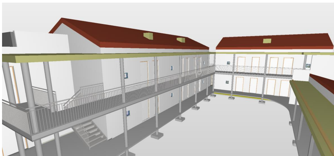
Figur 1: Ståltrapper og spilerekkverk vil bli montert i kommende periode
